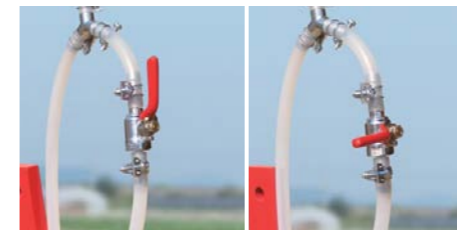
上段吐出側にある2方コックのレバー切替え操作で1段注入に即切替えが可能です。
