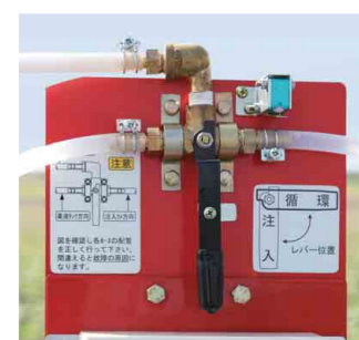
薬液循環装置 液ダレ防止に効果大 エア抜き時の薬液ロスを抑える
