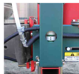
ピンチバルブ ポンプ駆動停止と同時に作動する 液ダレ防止装置
